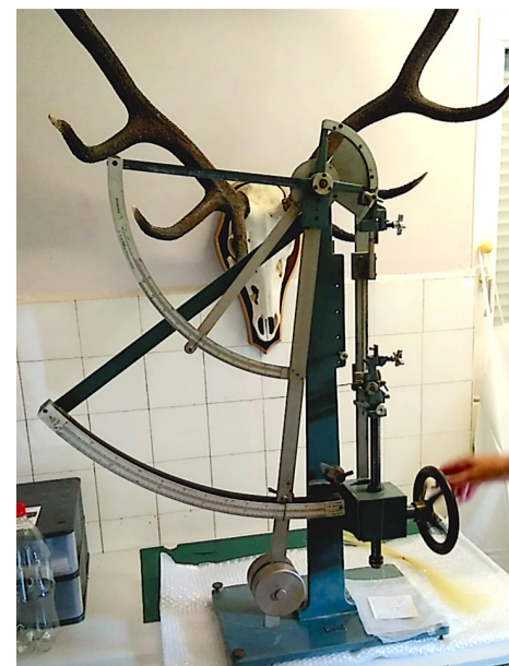
Historisches Darmsaiten-Messgerät im Besitz der Firma EFRANO, Zwota. (Bild: Bernhard Kainzbauer)
