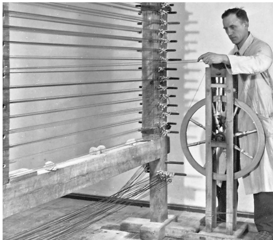
Nachdrehen der aufgespannten Darmsaiten um 1930. (Bild: Wilhelm Geipel, Saiten- und Catgutherstellung in und um Markneukirchen , Markneukirchen 2012, S. 24, mit freundlicher Genehmigung)
