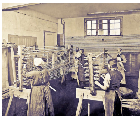
Waldemar Titzenthaler: Aufhängen der gedrehten Rohsaiten auf Spannrahmen 1918. (Bild: Wilhelm Geipel, Saiten- und Catgutherstellung in und um Markneukirchen , Markneukirchen 2012, S. 26, mit freundlicher Genehmigung)
